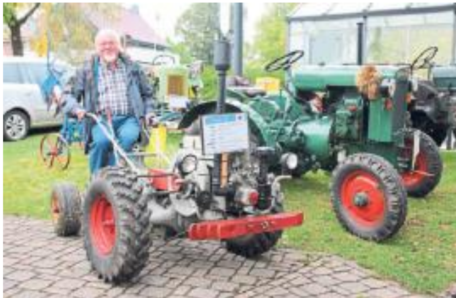
Franz-Josef Kellner von den Treckerfreunden Lippe und Umgebung mit dem 1946 in der Verlärer Schmiede als Eigenbau entstandenen Trecker. Das als Knicklenker 1946 gebaute Gefährt ist nach gründlicher Restaurierung wieder voll einsatzfähig.
